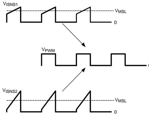
**Figure 20. Pulse-Level Transformation**
