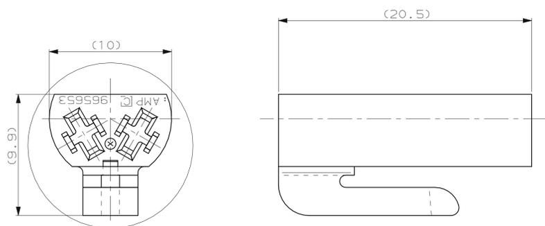
erforderliches Montageloch, min.Ø13.5mm
