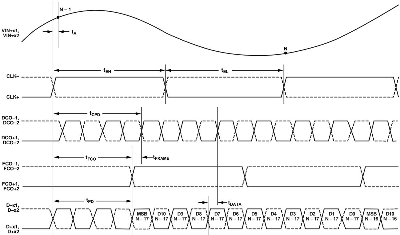
Figure 4. Wordwise DDR, 1x Frame, 12-Bit Output Mode
