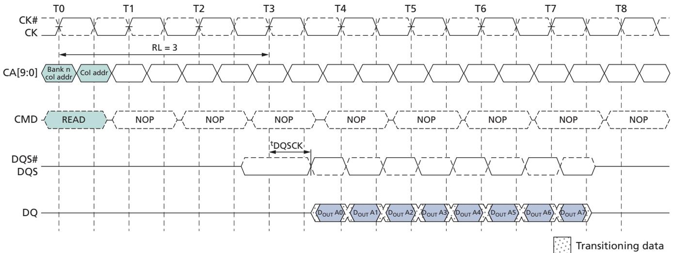
Figure 17:  $t_{DQSKDL}$  Timing
