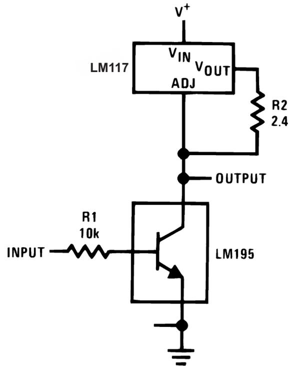
**Figure 27. Common-Emitter Amplifier**
