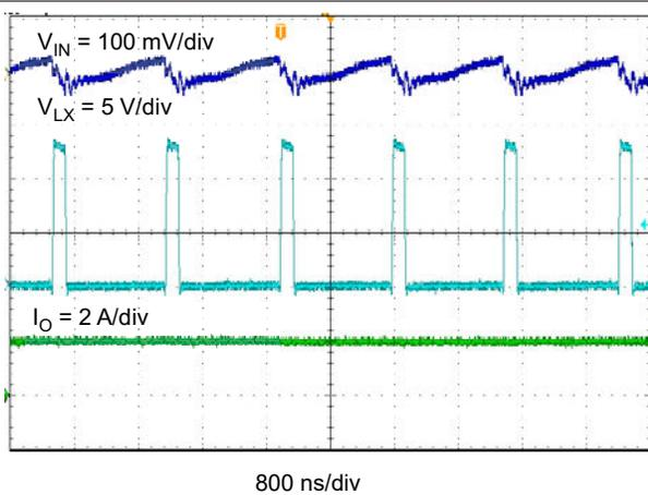
**Figure 8-6. TPS562201 Input Voltage Ripple**
