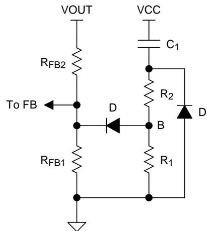
**Figure 11. Soft-Start Circuit**
