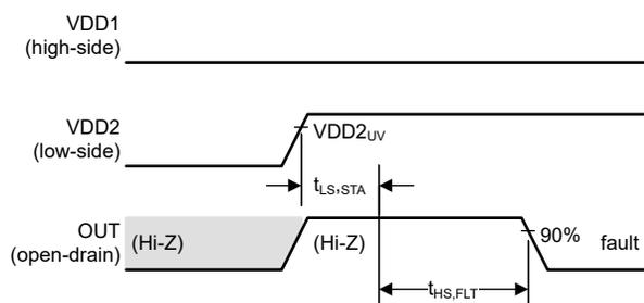
Figure 7-5. VDD2 Turns On, VDD1 Stays Off
